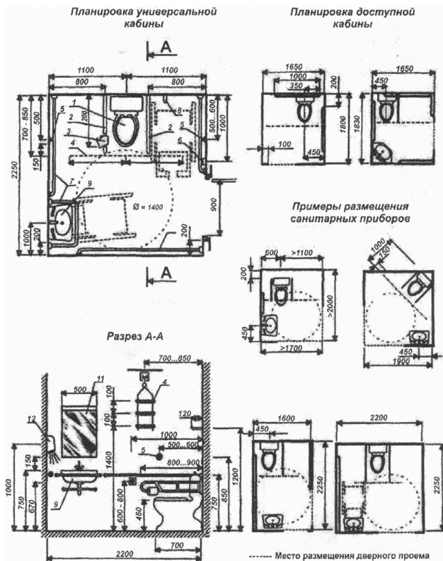
1 - унитаз; 2 - откидывающаяся опора для рук; 3 - бумагодержатель; 4 - штанга с навесными рукоятками; 5 - кнопка для слива воды; 6 - кнопка сигнализации; 7 - горизонтальный поручень; 8 - крючок для одежды; 9 - раковина с туалетной полкой; 10 - рычажовый удлинитель крана; 11 - зеркало; 12 - фен
