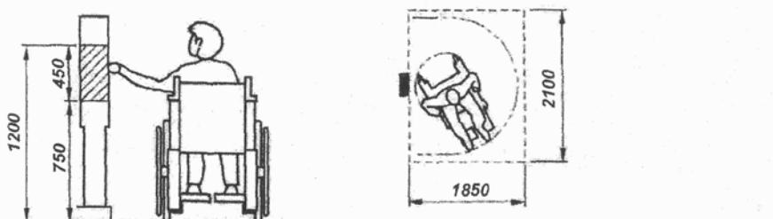
Рисунок Д.12. Кассы, телефоны-автоматы, платежные терминалы
